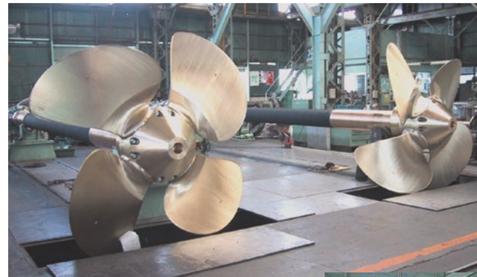
CPR 80A型 1,500kW用 CPP CPC-80A Type CPP for 1,500kW
